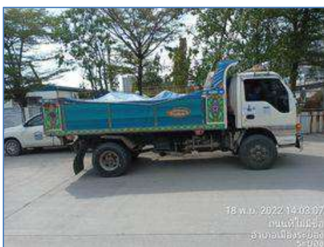
ภาพที่ 2-13 การปิดคลุมผ้าใบรถขนส่งวัสดุ
